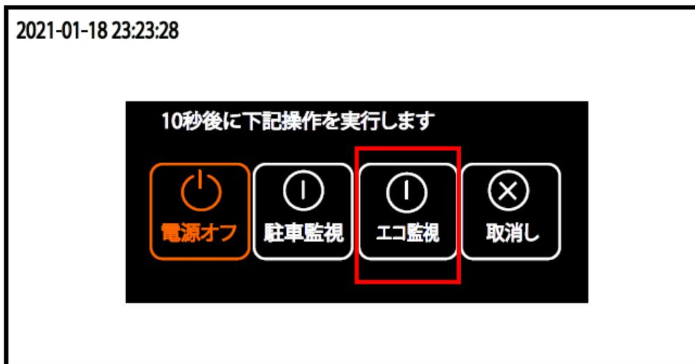
エコ監視は1 秒に1フレームずつ撮影する方式により映像ファイルのサイズを小さくすることで、従来の駐車録画保存方式に比べて省電力で長く録画映像を記録できます。10 分間の録画映像を約 20 秒間の映像に短縮して再生します。
