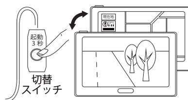
バックする際に、バックカメラ切替スイッチを押してください。
